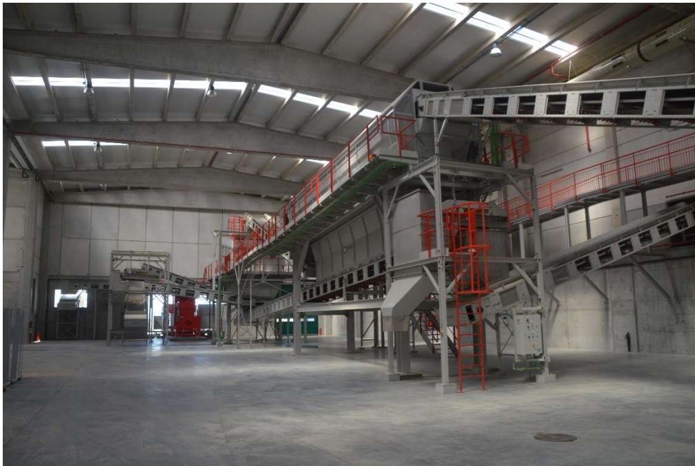
Figura 12: Circuit de cintes i màquines que separa la fracció orgànica de la fracció resta
