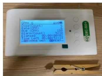
Figura 26. Detector Geiger comercial de la marca GQ Electronics, model GMC-500+ mesurant la radiació d'una font
