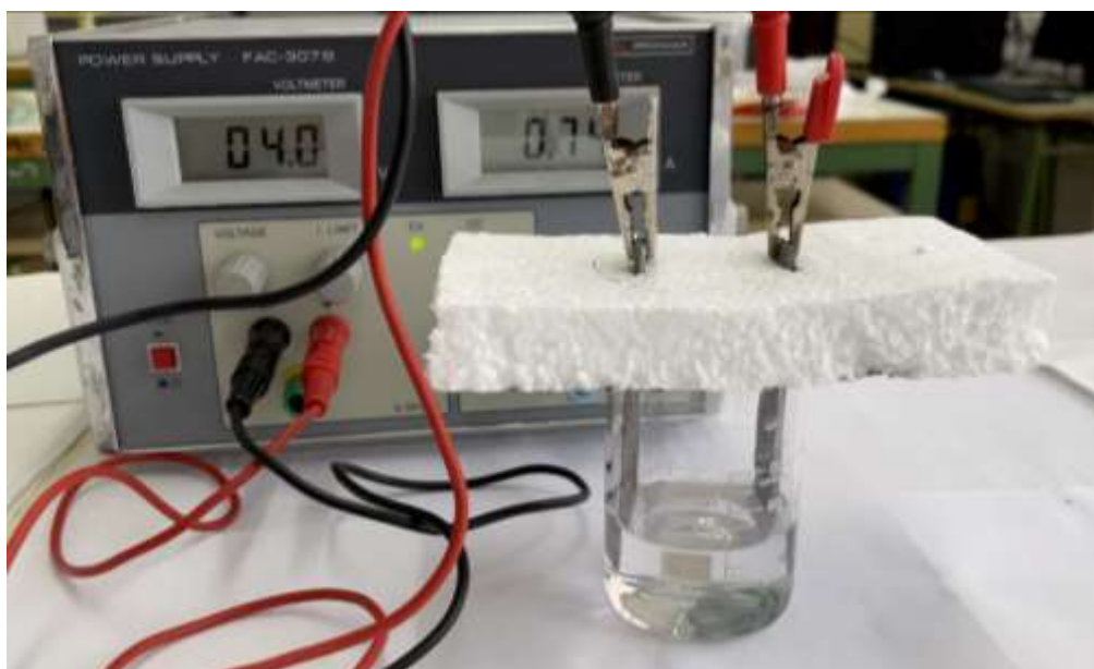
Figura 3.19. Pila de plom carregant-se per electròlisi.
