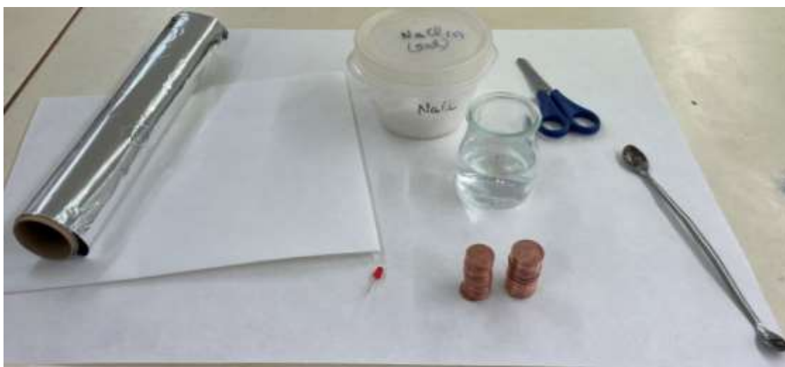
Figura 2.21. Material per realitzar una bateria similar a la que va fer Alessandro Volta fa uns dos-cents anys.
