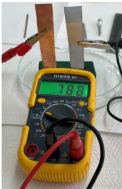
Figura 2.45. Pila zinc-coure amb l'escuma floral com a pont salí.
