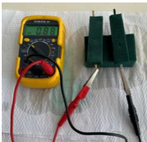
Figura 2.38. Voltatge de la variant de la pila Daniell zinc-coure amb escuma floral.
