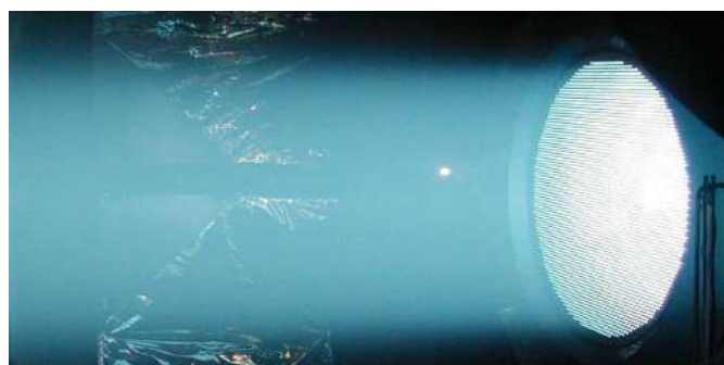
Testatge del motor de propulsió iònica NEXIS. Allò que a la foto sembla un feix de llum són, en realitat, ions propulsats per forces elèctriques. (en.wikipedia.org)
