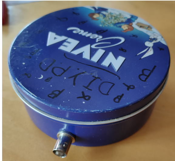
Figura 12: Caixa metàl·lica que aïlla el detector de la radiació ambiental. El piu de metall que sobresurt és un connector BNC que serveix per endollar el detector a un oscil·loscopi o a un ordinador.
