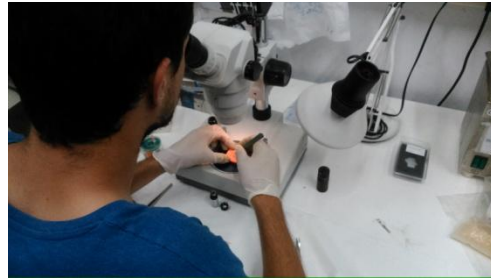
Imatge 6: Procés per a contactar una mostra pirolejada
