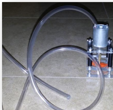
Figura 5.11 Actuator emprat: bomba d'aigua.
