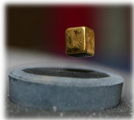
A la imatge podem veure un imant levitant a sobre d'un superconductor per l'efecte Meissner.
