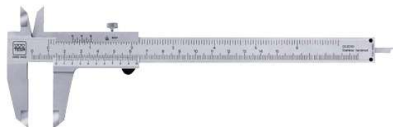
Peu de rei. Mesura 0-150 mm. Apreciació 0,05mm. Mesura: Exterior; interior; profunditat. Inoxidable.
