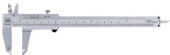
Peu de rei. Mesura 0-150 mm. Apreciació 0,05mm. Mesura: Exterior; interior; profunditat. Inoxidable.
