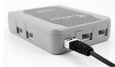
Un sensor analògic connectat a LabQuest Mini
