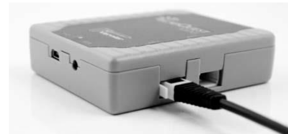
Un sensor digital connectat a LabQuest Mini
