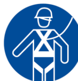
Protección individual obligatoria contra caídas
