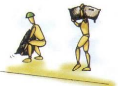
Necesidad de modificar la posición de agarre con la carga suspendida
